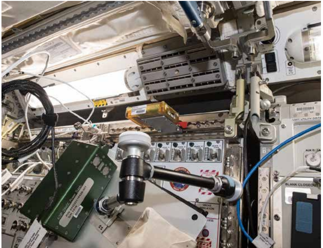
WICO-Modul verbaut auf der ISS: Das Wireless Compose (WICO)-Modul im orange-transparenten Gehäuse wiegt 200 Gramm und hat die Größe einer Zigarettschachtel. (Quelle: DLR)
